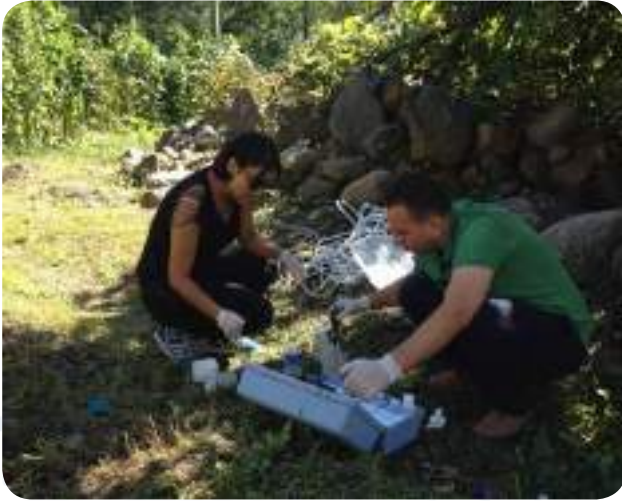
Fotoğraf- 103 İlçe Merkezinde Kanalizasyon Yapısının Alıcı Ortama Atık Su Deşarj Ettiği Noktadan Numune Alımı
